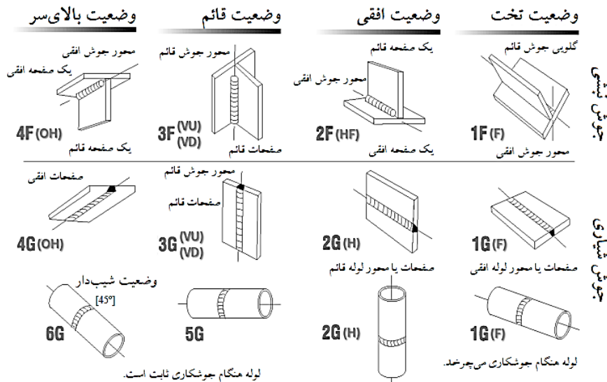
شکل ۳-۸. وضعیت‌های مختلف جوشکاری.
